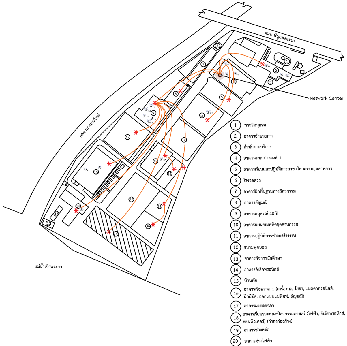
ภาพที่ 3-6 แผนผังบริเวณการเชื่อมต่อระบบเครือข่ายศูนย์พระนครเหนือ
